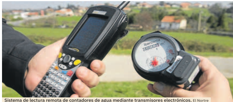
Sistema de lectura remota de contadores de agua mediante transmisores electrónicos. El Norte
